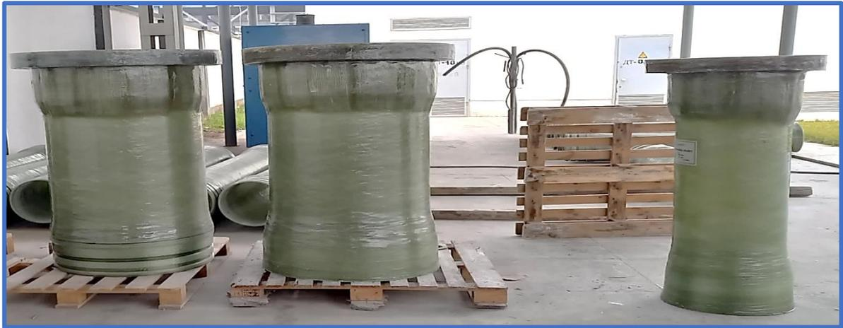
Рис. 10. Втулка под фиксированным фланцем,  $\text{Ø}$ -700мм,  $\text{Ø}$ -400мм.
