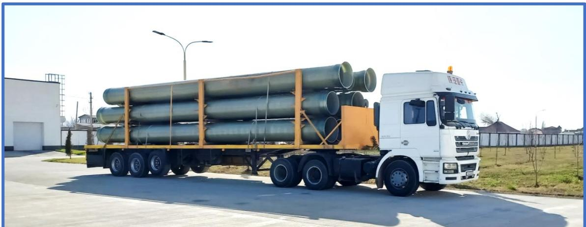
Рис. 18. Транспортировка композитных труб  $\text{\O}$ -600мм
