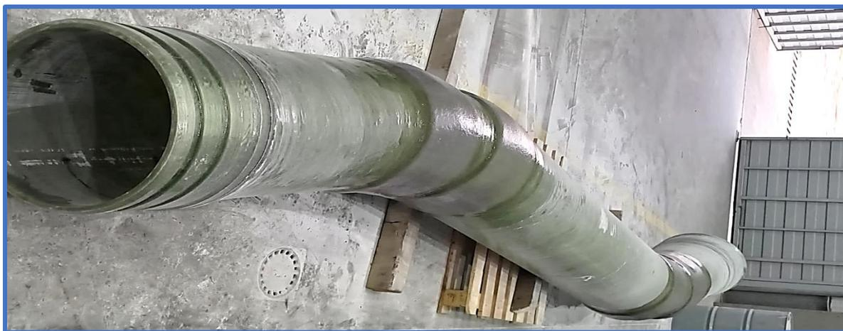
Рис. 7. Сегментный отвод раструбный с ниппелями  $\text{Ø}$ -500мм.  $25^\circ$  2шт.
