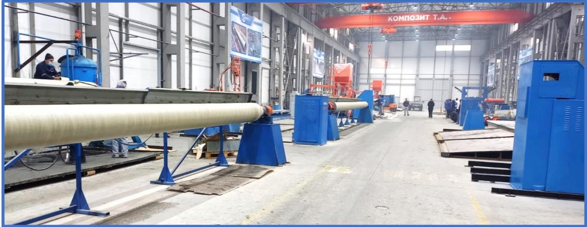
Рис. 16. Процесс сушения труб  $\text{\O}$ -400мм.
