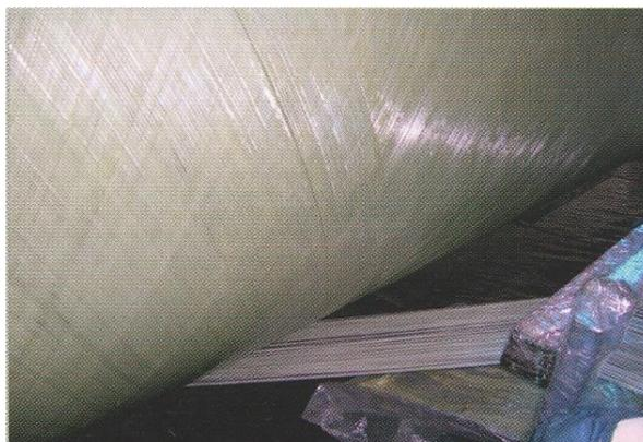
Структурные стены состоят из множества радиальных и спиральных слоев, намотанных под разными углами в соответствии со схемой намотки.
