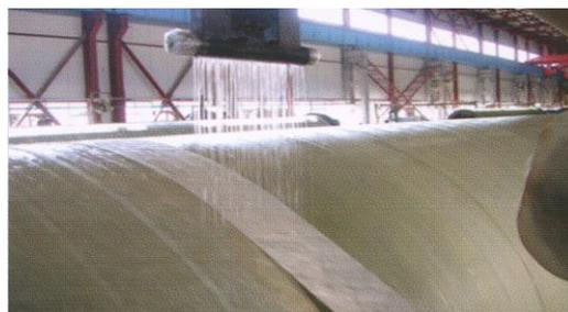
Конструкция трубы состоит из внутреннего слоя - лайнера, насыщенного смолой, структурных стен и слоя жесткости.
