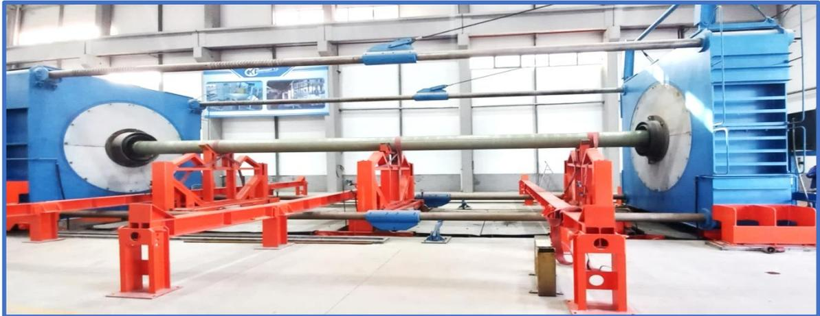
Рис. 17. Процесс гидравлического испытания труб  $\text{\O}$ -400мм.
