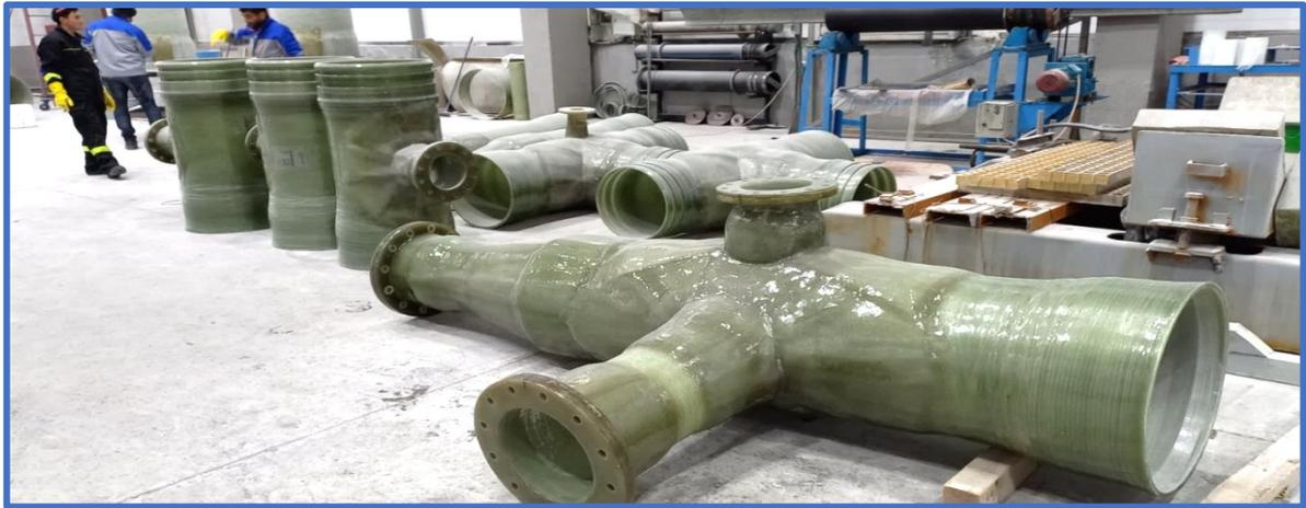
Рис. 4 Сегментные редуционные тройники, крестовины фланцевые Ø-400-500мм.
