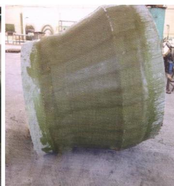
С целью обеспечения герметичности фитингов, они производятся методом резки и последующей ламинации пройденных контроль качества готовых труб.
