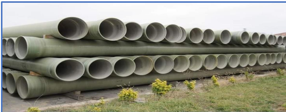
Рис. 1 Складирование композитных труб  $\varnothing$ -400мм.
